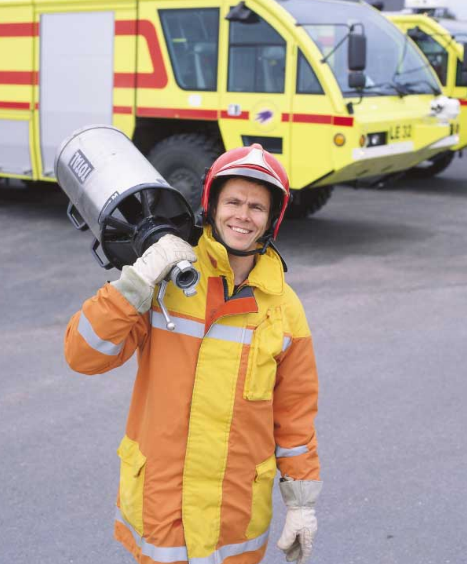
Palomies Pasi Karjalainen kantaa olallaan vaahdonsekoitinta. Vaahto syntyy, kun letkusta tuleva vesi ja vaahdoneste sekoittuvat ilmaan.
