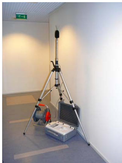
Kuva 1. Lochard Emu2200 melumittari ja ulkomikrofoni jalustallaan
