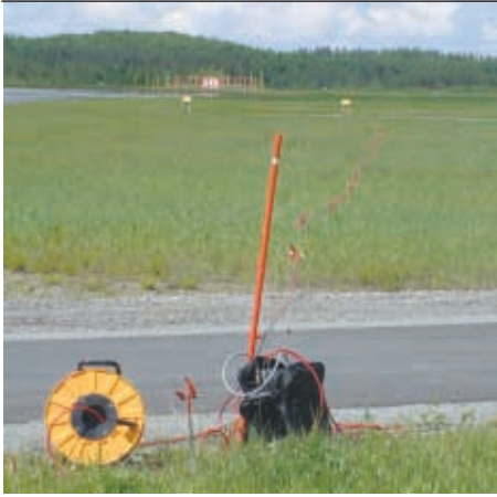
Sähköisen maavastusluotauksen laitteiston soveltuvuutta liukkaudentorjunta-aineiden levinneisyyden selvittämiseen on testattu Joensuun lentoasemalla.
