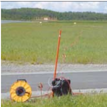
På flygplatsen i Joensuu har man testat om utrustning för elektronisk lodning av jordmotståndet kan användas för att utreda halkbekämpningsmedlens spridning.
